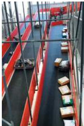
自動分揀系統能按地址自動為快件分類，直接送到快件目的地所屬地區的貨車中，大大加快物流速度。
