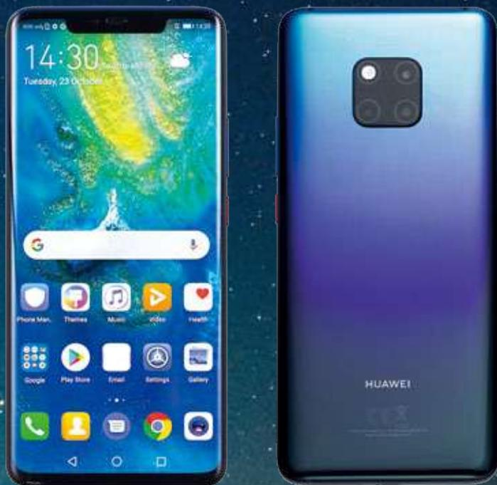
貴為今年HUAWEI旗艦手機頂尖之作，Mate 20 Pro從內到外引入嶄新設計及科技，成就全新機王。它配備7nm製程生產的Kirin 980 AI處理器，引入大、中、小三組核心設計，其中兩個大核及兩個中核均建基於效能強悍的全新Cortex-A76架構開發，加上節能優化的四核Cortex-A55，速度更高亦更省電。同時Kirin 980的NPU（神經網路處理單元）更由上一代一個倍增至兩個，令AI運算能力大增。外觀方面，Mate 20 Pro採用3D八曲面玻璃機身，手感極佳。配合6.39吋OLED 3,120 x 1,440 2K+全面屏帶來無邊視界，無論暢玩遊戲與欣賞影片都極具震撼。
