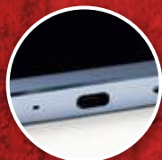
機底用上USB Type-C插座，支援Quick Charge 3.0快速充電。
